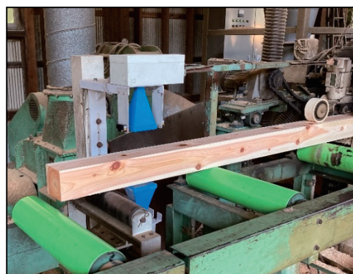
含水率、ヤング係数を測定するグレーディングマシン
