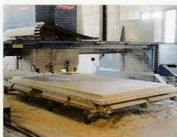
図2:CNCによるCLTの加工
