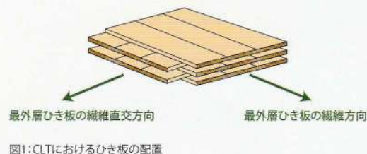
図1:CLTにおけるひき板の配置
