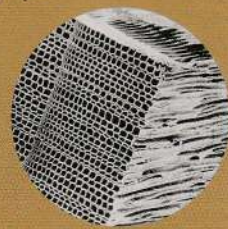
【木の細胞 電子顕微鏡写真(ヒノキ)】 電子けんび鏡で見ると木は無数の穴でできている。 このスキマ間に空気がたまり、これがクッションとなって 熱や衝撃を伝えにくくしているんだ。
