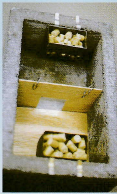
床材の嗜好性試験用の飼育箱 ~コンクリートvs合板内張
