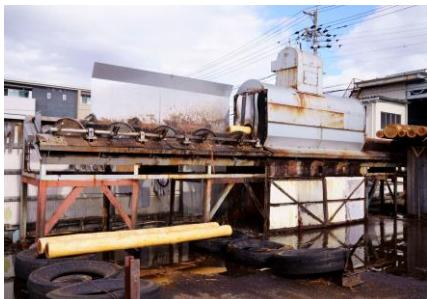
丸太に傷が付きにくい水圧式皮むき機
