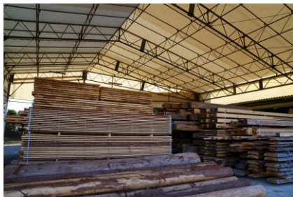
屋根付の天然乾燥材置場
