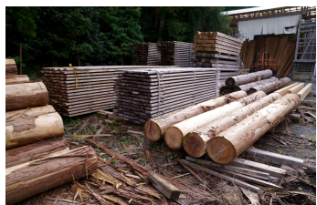
天然乾燥材の置場
