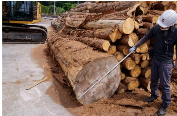
切削機は直径90cmの原木をそのまま投入できる
