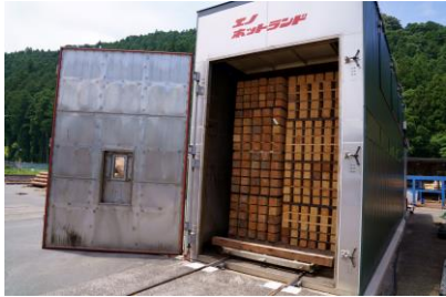
高温蒸気式の人工乾燥機
