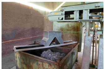
金属類を取り除く磁力選別機
