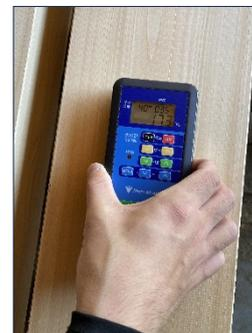
含水率計による含水率の測定
