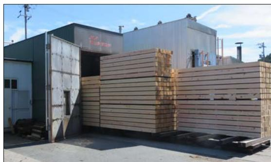
人工乾燥処理装置：木材乾燥機
